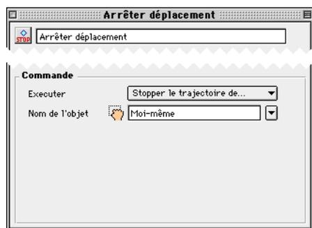
La commande Arrêter déplacement possède plusieurs arguments qui peuvent être définis par : le menu local Exécuter, la zone de dépose Nom de l'objet.
