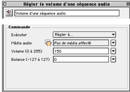
La commande Volume d'une séquence Audio possède plusieurs arguments qui peuvent être définis par : le menu local Exécuter, la zone de dépose Média audio et les zones de saisie Volume (0 à 255) et Balance (-127 à +127).
