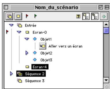
Le déplacement de l'icône d'un écran, à l'aide de la souris, dans la fenêtre Scénario et en dehors de la séquence à laquelle il appartient, sélectionne (fait apparaître en grisé), lors de son survol, chacune des séquences dans lesquelles il peut être intégré.
